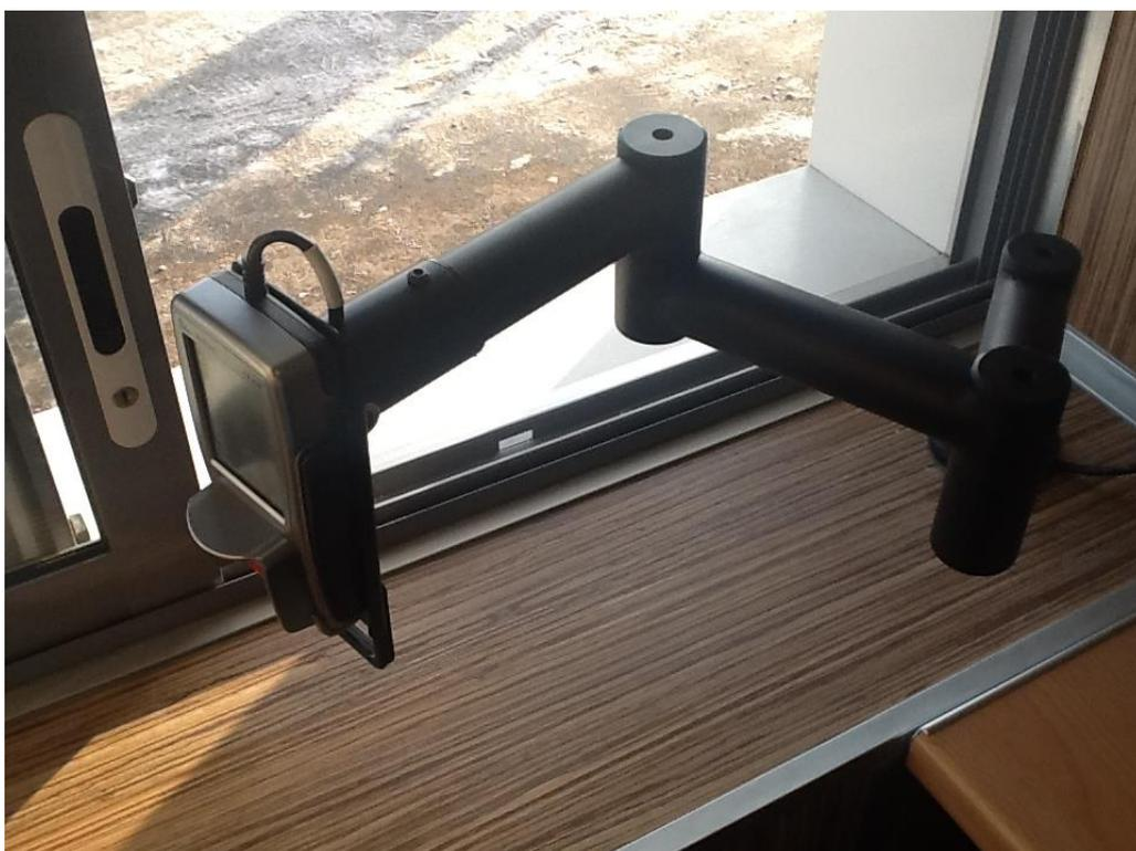
Если несущая поверхность не твёрдая (например это пластиковый подоконник), то ТУРЕЛЬ необходимо ставить на ОПОРНУЮ ПЛАСТИНУ (Поставляется отдельно)
